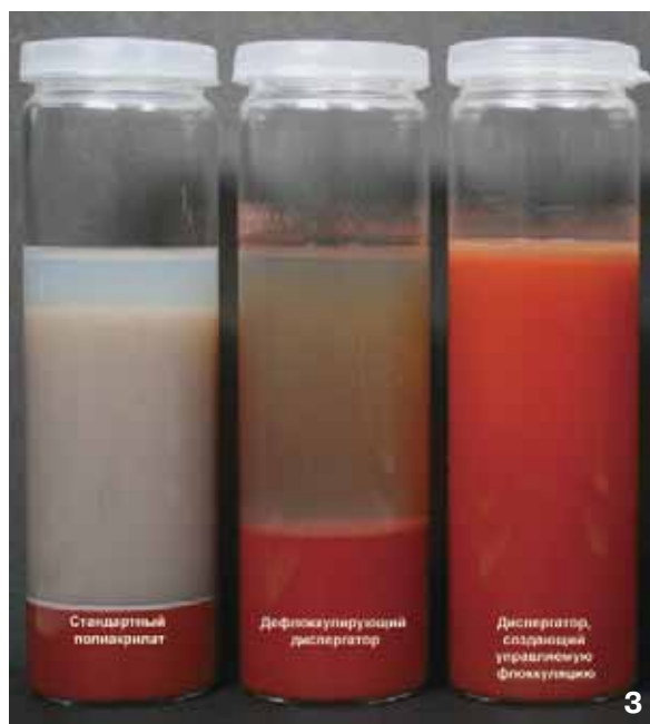
Рис. 3. Стойкость пигмента/наполнителя к оседанию в водоразбавляемой грунтовке; условия хранения — 3 месяца при комнатной температуре
