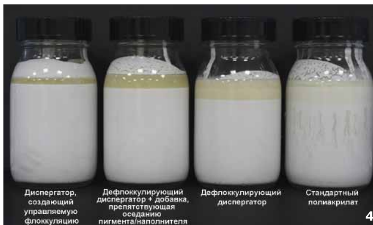
Рис. 3. Стойкость пигмента/наполнителя к оседанию в водоразбавляемой грунтовке; условия хранения — 3 месяца при комнатной температуре
